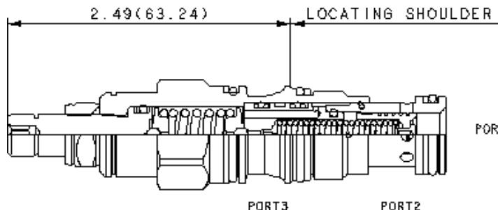
Diese 3-Wege-Druckwaage ist ein in der Ruhestellung geschlossenes Regelement mit Druckbegrenzungsfunktion, das zusammen mit einer externen Blende zwei Funktionen erfüllt: Der Hauptkolben der 3-Wege-Druckwaage hält die Druckdifferenz über die externe Blende konstant. Überschüssiger Volumenstrom wird zum Tank (Anschluss 2) abgeführt. Bei Erreichen des Druckeinstellwerts verhält sich das Ventil wie ein Druckbegrenzungsventil.
